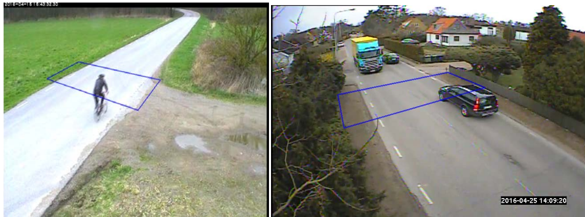
Figur 32. Video med zon för att mäta interaktion och sidoläge, källa LTH
